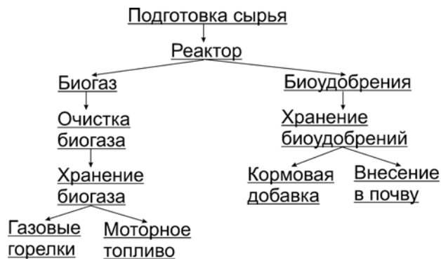
Рис. 1. Схема переработки органических отходов на биогазовых установках
