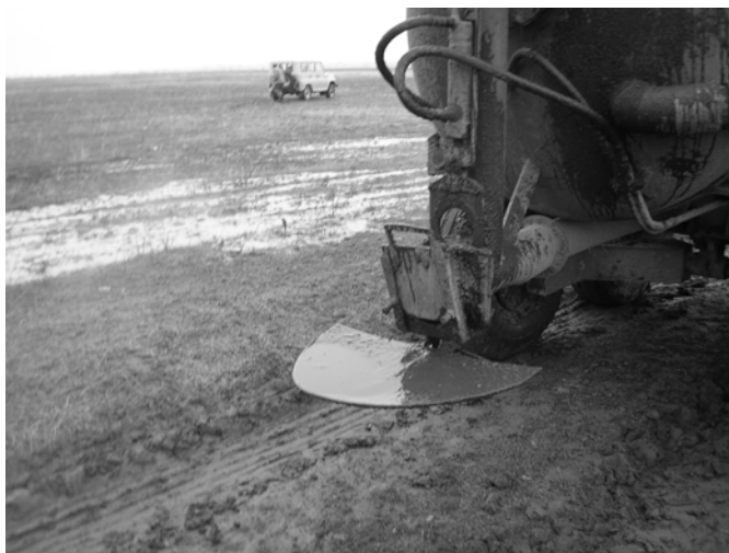
Рис. 48. Пластина для разбрызгивания биоудобрений Фото: Веденев А.Г., ОФ «Флюид»
