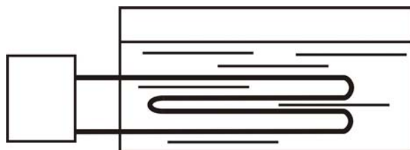
Рис.27. Устройство для непрямого подогрева сырья
