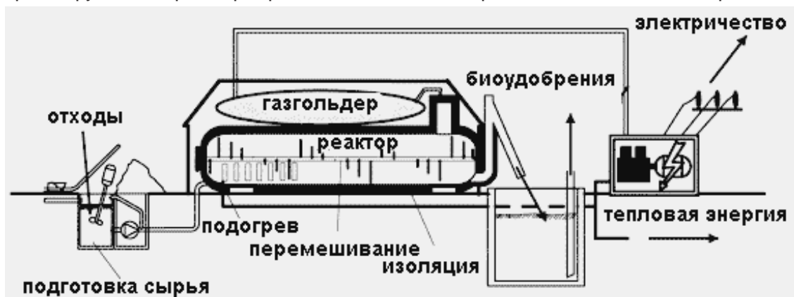
Рис. 18. Типичная для развитых стран биогазовая установка с мягким газгольдером
